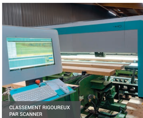
LIGNE DE PRODUCTION AUTOMATISÉE DÉDIÉE AUX LITEAUX
